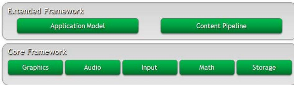
XNA Framework содержит в себе элементы, которые необходимы для разработки игр, например, библиотека функций для работы с матрицами и векторами, библиотека для унифицированной работы с устройствами ввода и т.д. Более того, XNA Framework содержит дополнительные элементы (Extended Framework), которые решают многие вопросы, возникающие в процессе разработки игры.
